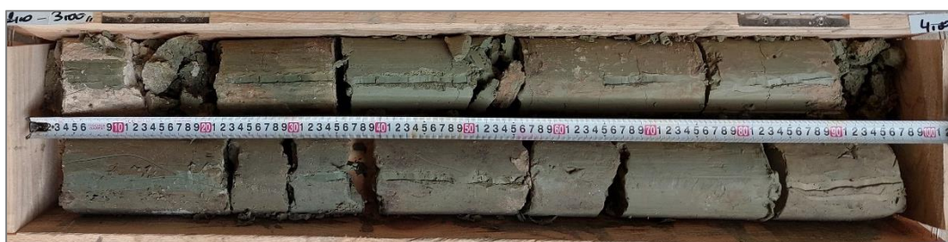
Photo 3 : Horizon de l'Argile verte au droit du sondage SC3 entre 3,0 et 5,0 m/TN
