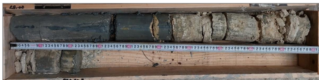
Photo 6 : Toit des Masses et Marnes du gypse au droit du sondage SC1 entre 29,0 et 30,2 m/TN
