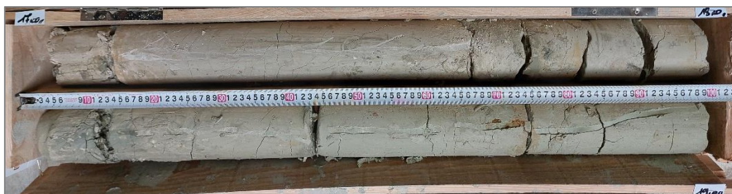
Photo 4 : Marnes de Pantin au droit du sondage SC1 entre 17,0 et 19,0 m/TN
