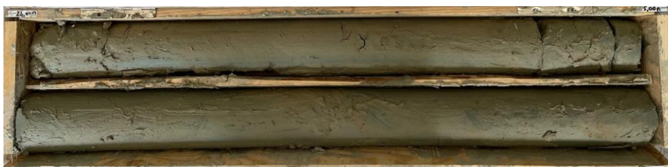
Photo 9 : Marnes d'Argenteuil au droit du sondage SC3 entre 24,0 et 26,0 m/TN
