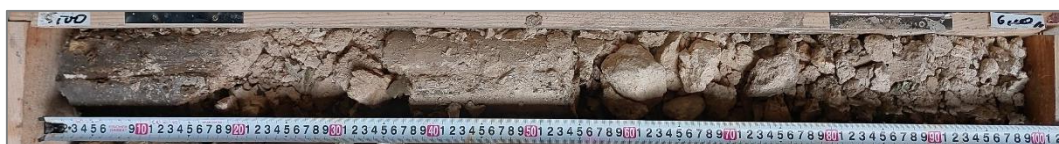
Photo 2 : Transition Remblais / Calcaire de Brie au droit du sondage SC1 entre 5,0 et 6,0 m/TN
