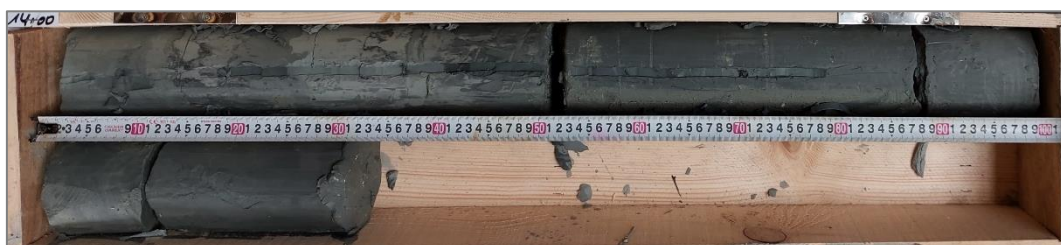
Photo 5 : Marnes d'Argenteuil au droit du sondage SC3 entre 14,0 et 15,3 m/TN
