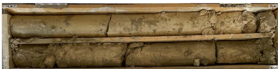
Photo 8 : Marnes de Pantin au droit du sondage SC1 entre 19,0 et 21,0 m/TN
