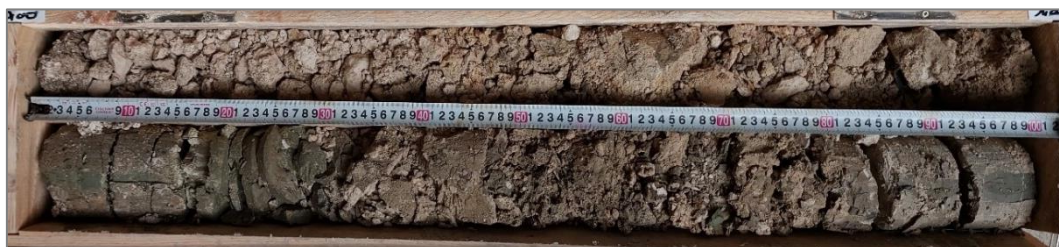
Photo 1 : Remblais au droit du sondage SC2 entre 0,0 et 2,0 m/TN
