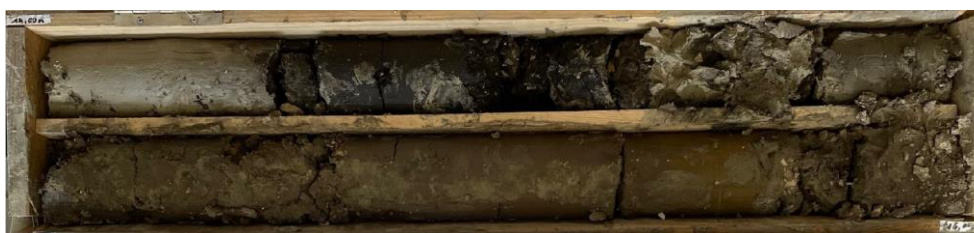
Photo 7 : Remblais au droit du sondage SC23 entre 14,0 et 16,0 m/TN
